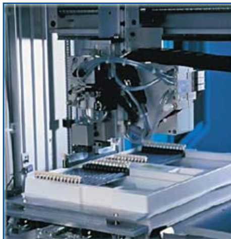
Рис. 9. Питатель для подачи компонентов из поддонов
