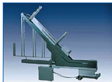
Рис. 5. Питатель для подачи компонентов из пеналов, расположенных под углом
