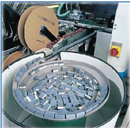
Рис. 7. Питатель для подачи компонентов из россыпи
