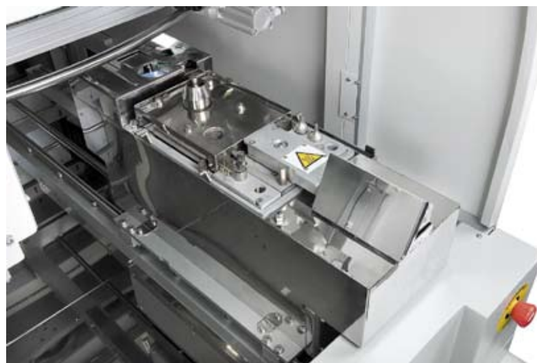
Рис. 5. Ванна припоя с банком сменных насадок
