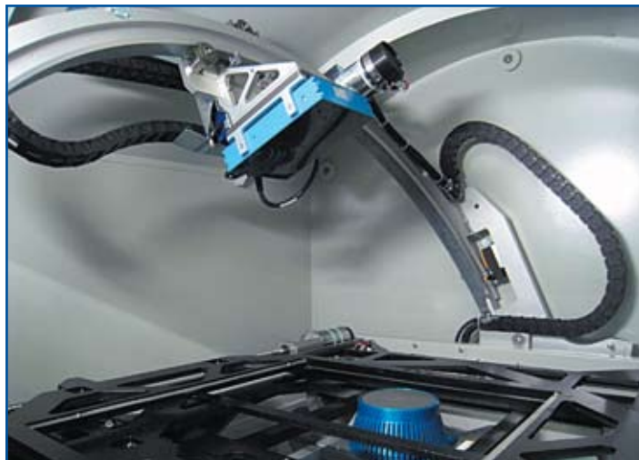
Рис. 13. Система рентгеновского контроля Nordson DAGE с плоскопанельным детектором
