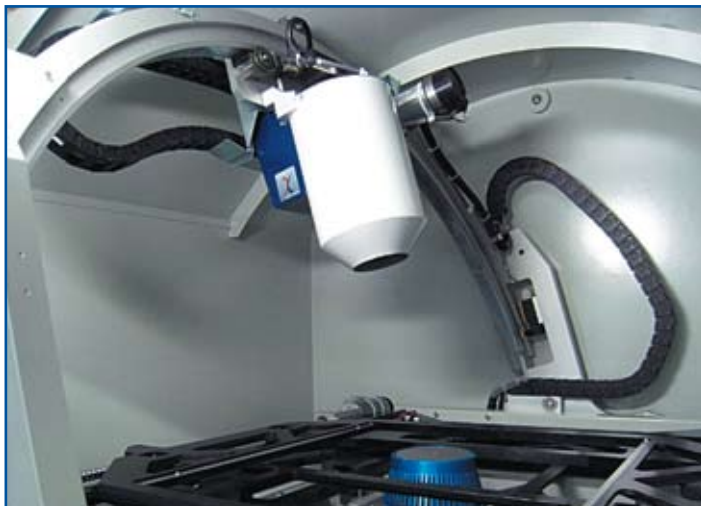
Рис. 12. Система рентгеновского контроля Nordson DAGE с усилителем изображения
