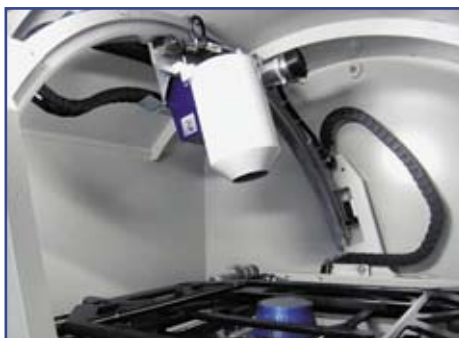
Рис. 1. Система рентгеновского контроля с усилителем изображения над просвечивающей рентгеновской трубкой (исследуемый образец отсутствует)
