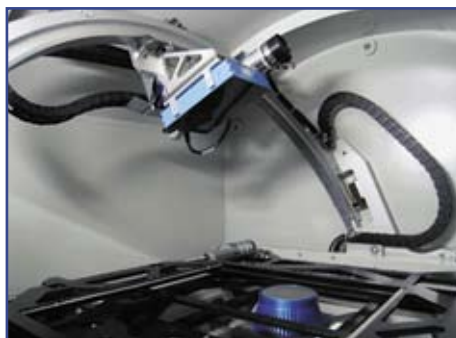
Рис. 2. Система рентгеновского контроля с плоскочувствительным детектором на пластине из кристаллического кремния над просвечивающей рентгеновской трубкой (исследуемый образец отсутствует)
