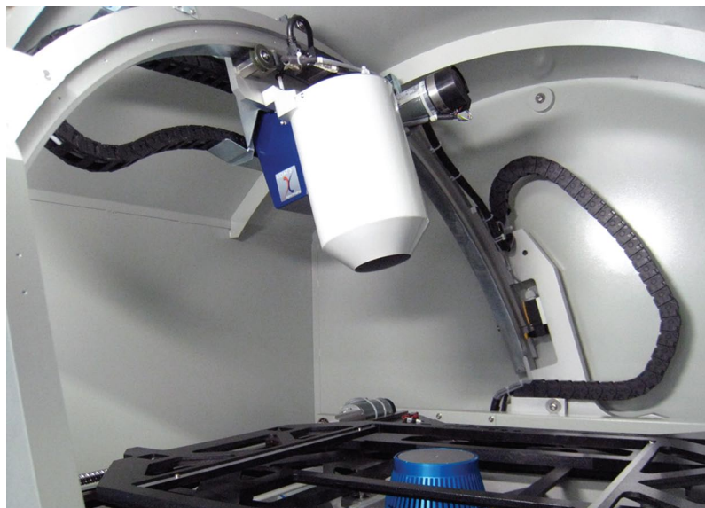
Рис. 3. Усилитель изображения в системе рентгеновского контроля Nordson DAGE
