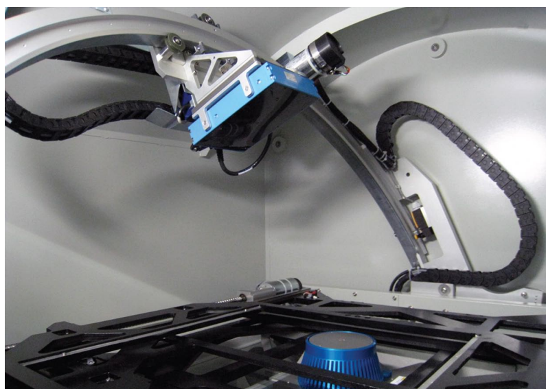
Рис. 4. Плоскопанельный детектор в системе рентгеновского контроля Nordson DAGE
